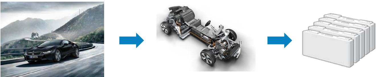
**Abb. 1:** BMW i8 Fahrzeug – innere Struktur mit u. a. elektr. Antriebsstrang inkl. Hochvolt-Speicher – Zelle.
